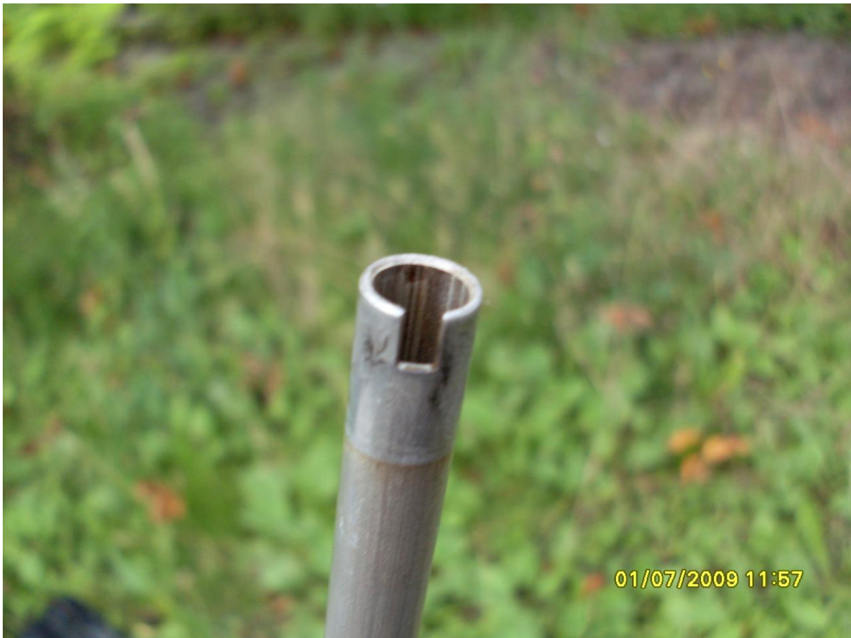
Einkerbung für das Endstück, damit auch alles in der richtigen Richtung montiert wird...
