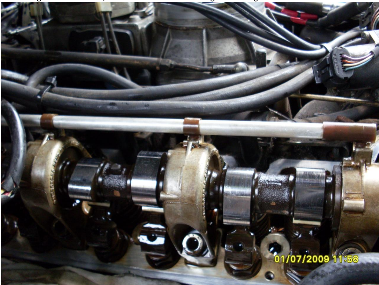
Dusche mit neuen Teilen aufgelegt... Anschließend nur noch „festhämmern“ ;-)
