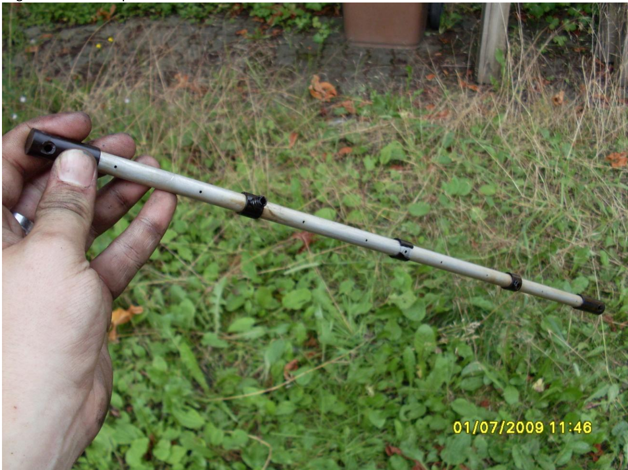
Komplette Öldusche mit den alten Teilen dran...
